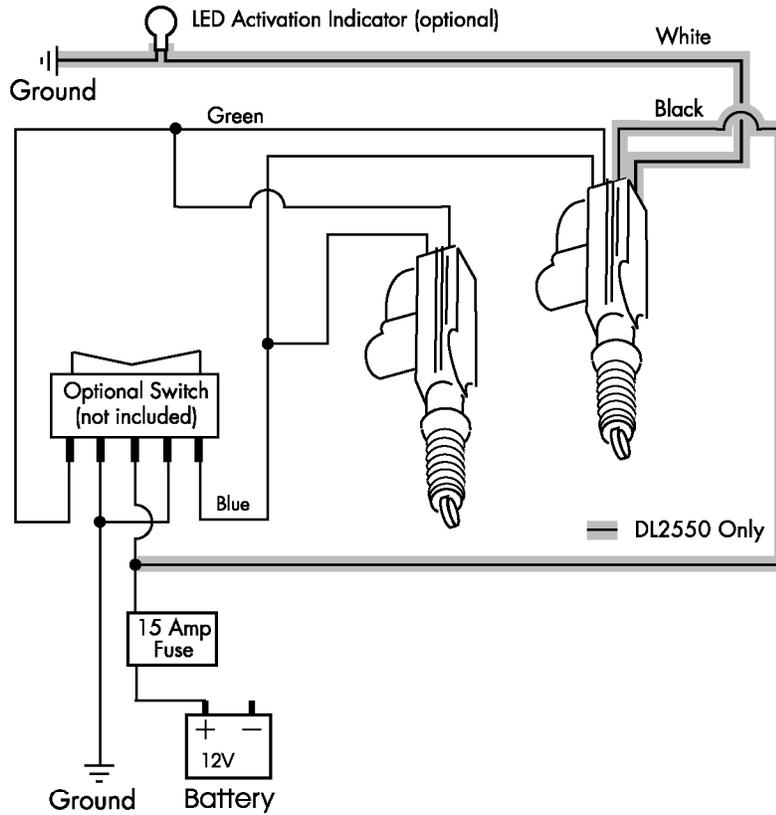
**IGNITION CONTROL MODULE WIRING DIAGRAM**
